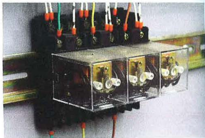
Figura 7.79. Relés de control industrial.
